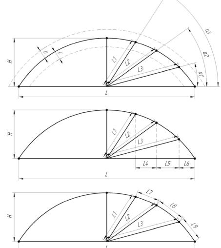
Можно комбинировать замеры из вариантов 1...3. Например, замерять длины L4,L5,L6 и L7,L8,L9 или углы a1,a2,a3 и длины L7,L8,L9. Таким образом, каждая точка должна иметь две координаты.
